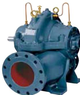
Pompe in ghisa. Molto compatte per una facile installazione e il minimo mantenimento. L'intelaiatura assiale permette la rimozione facile dell'intelaiatura superiore per l'ispezione ed il servizio. Le parti rotanti sono in materiale anticorrosivo. Adatte per il rifornimento d'acqua, la circolazione dell'acqua fredda e calda, per le torri di raffreddamento, irrigazione, uso industriale, prosciugamento, spruzzare e condizionamento d'aria.
