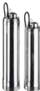
Elettropompe centrifughe multistadio sommerse adatte alla movimentazione di acqua limpida da pozzi, cisterne e serbatoi di prima raccolta. Impiegate per la pressurizzazione di impianti domestici, piccola irrigazione, lavaggio veicoli e incrementi di pressione in genere. Provviste di doppia tenuta meccanica con camera interposta ad olio. Fornite con 20 m di cavo di alimentazione tipo H07RN-F, 5 m per il modello IDROGO 40/06 M. Versione monofase con galleggiante a richiesta (versione "A").
