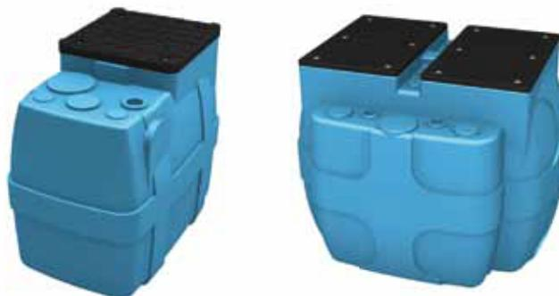
Vasche di raccolta per acque reflue caratterizzate da costruzione robusta, di facile installazione ed equipaggiate con curva di passaggio rapido. Serbatoio in polietilene da 200 e 600L completo di coperchio con guarnizione in EPDM espanso e bulloneria in acciaio inox AIS I304. Disponibile nella versione base e nella versione allestita "E".
