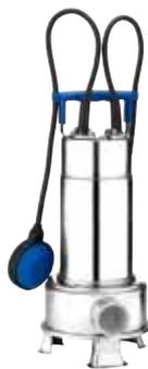
Elettropompe sommergibili particolarmente adatte alla movimentazione di liquidi carichi contenenti sostanze solide e/o filamentose in sospensione. Adatte per lo svuotamento di acque di infiltrazione, movimentazione di acque di scarico luride (servizi sanitari), svuotamento di pozzi neri e scarico nelle fognature. Provviste di 5 m cavo di alimentazione tipo H07 RN-F e disponibili con o senza galleggiante (a richiesta 10 m cavo H07 RN-F)
