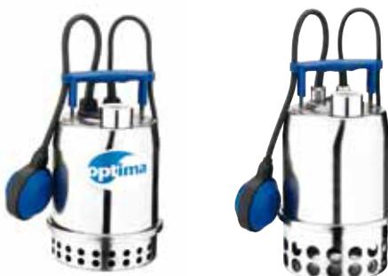
Elettropompe sommergibili impiegate per la movimentazione di acque di infiltrazione, svuotamento di cantine, garage e scantinati, drenaggio di piccoli e medi cantieri. Per la loro versatilità possono essere utilizzate in installazioni fisse o mobili. Provviste di 5 m cavo di alimentazione tipo H05 RN-F per i modelli monofase e H07 RN-F per i modelli trifase (10 m cavo per uso esterno) e disponibili con o senza galleggiante.
