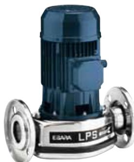
Elettropompe centrifughe in-line con idraulica in acciaio inossidabile AISI 304. Versatili, silenziose e particolarmente indicate per la movimentazione di liquidi in impianti di circolazione, di riscaldamento civili e industriali. Impiegate per la movimentazione di acqua calda sanitaria, liquidi a bassa pressione in genere e in impianti di raffreddamento e condizionamento.
